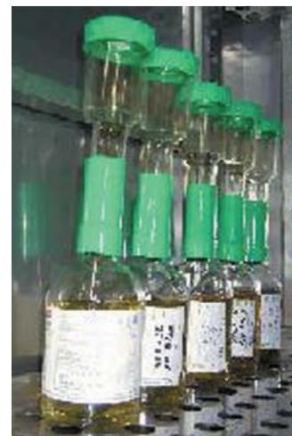
薬剤を合成後、半減期、発熱性物質、pH、放射化学的純度、残留試薬などの検定を行います。全ての検査項目に合格したことを確認してから、薬剤をPET検査に使用します。
