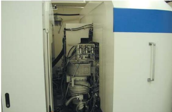
自己遮蔽型サイクロロンで水( $^{18}\text{O}$ - $\text{H}_2\text{O}$ )から放射性核種( $^{18}\text{F}$ )を製造します。
