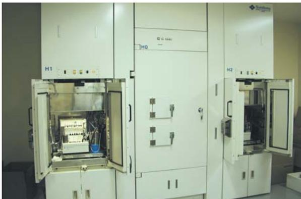
鉛で覆われたセル内に設置した自動合成装置で薬剤を合成します。あらかじめ試薬類をセットした後、 $^{18}\text{F}$ を導入し遠隔操作で薬剤を合成します。
