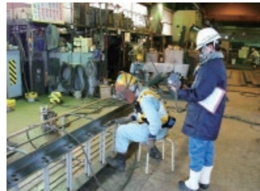
粉じん作業場(造船所)の測定状況
