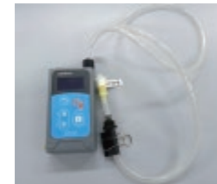
サンプラーとポンプ
